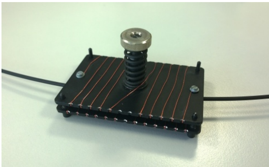
Obr. 5.6: Přípravek pro měření citlivosti mikroohybů
