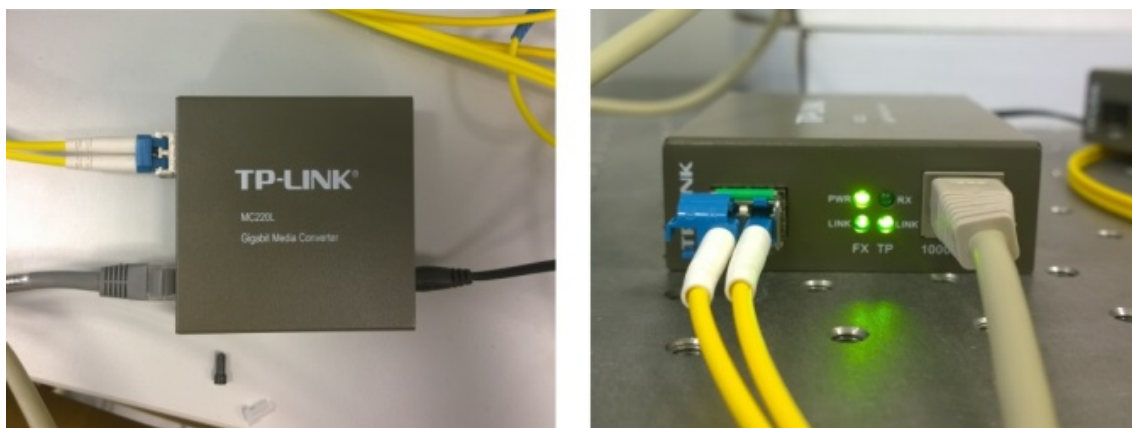
Obr. 6.4: Převodník TP-LINK MC220L
