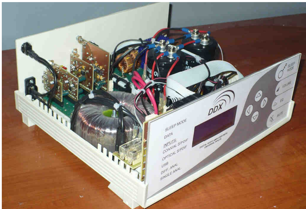
I.8.1: Zrealizovaný prototyp zesilovače bez horního krytu – pohled zleva
