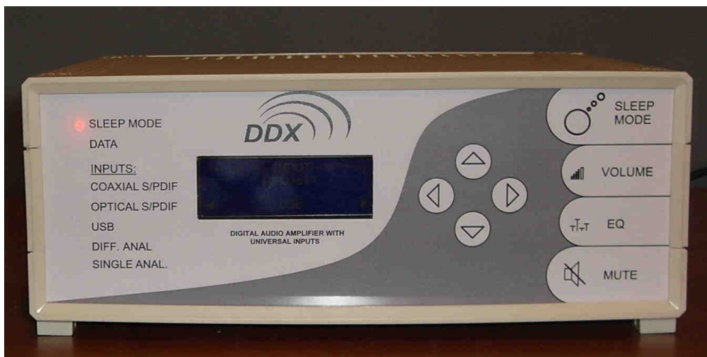
I.8.9: Zrealizovaný prototyp zesilovače v režimu Stand-By – pohled na čelní panel
