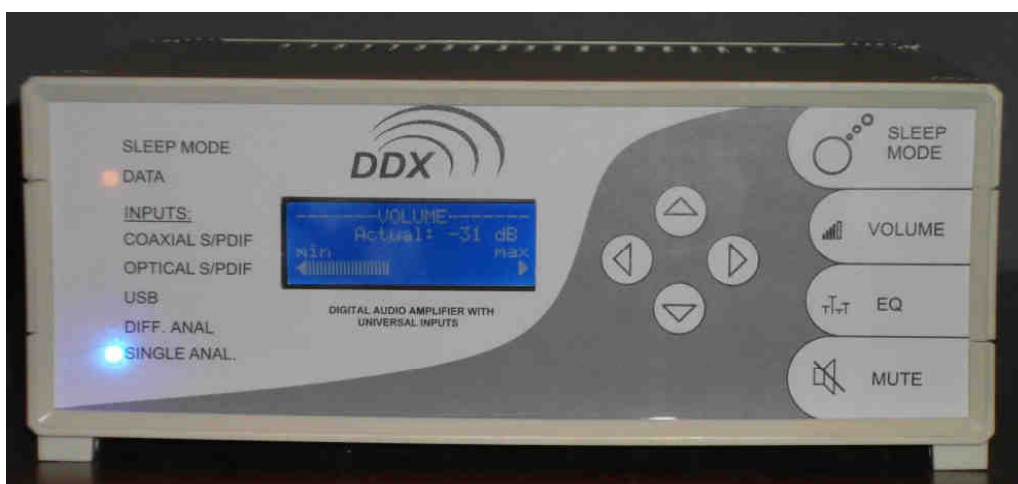
I.8.8: Zrealizovaný prototyp zesilovače v provozu – pohled na čelní panel
