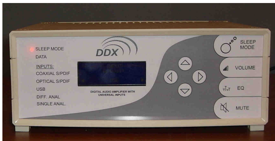
Obr. 5.4: Fotografie zesilovače v režimu Stand-By
