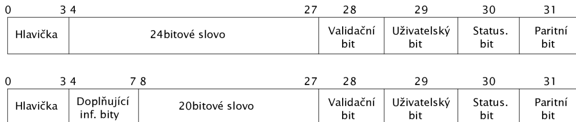
Obr. 1.9: Struktura subrámců standardu AES3 (převzato z [9] a upraveno)
