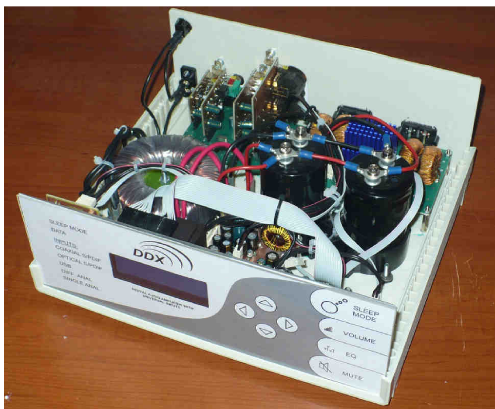
I.8.2: Zrealizovaný prototyp zesilovače bez horního krytu – pohled zprava
