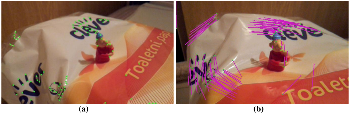
Obrázok 17: Optický tok videa. (a) Inicializačná snímka. Sledované kľúčové body sú zvýraznené zeleným krúžkom. (b) Snímka z videa z iného pohľadu. Fialové čiary indikujú pôvodnú polohu kľúčových bodov.
