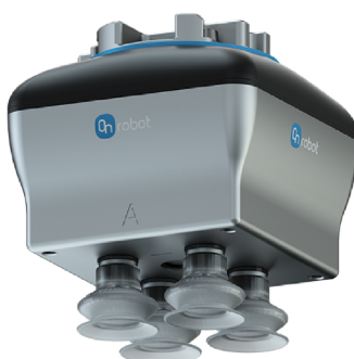
Obrázek 2.3: VGC10 vakuový gripper
