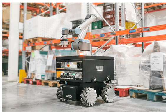
Obrázek 1.4: AMR robot s mechanickým manipulátorem
