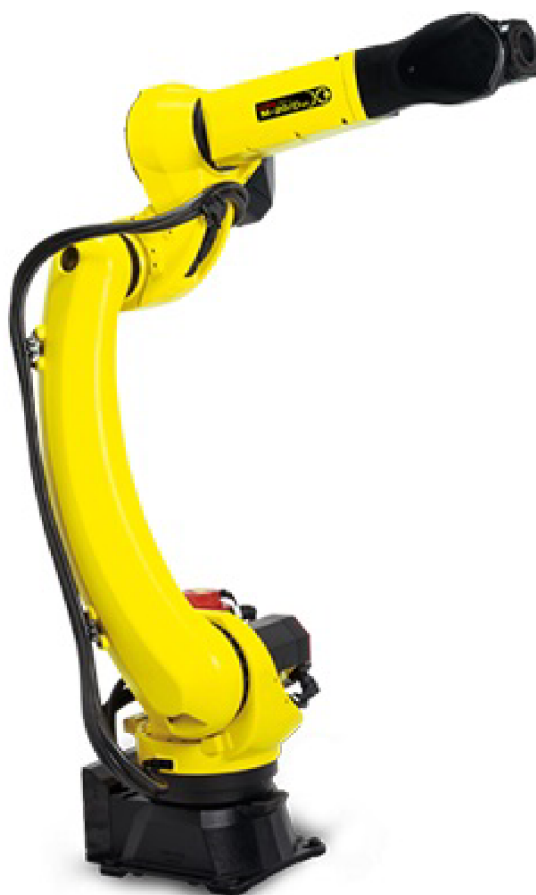
Obrázek 5.4: Fanuc M-20iD/25 - vhodný pro manipulaci
