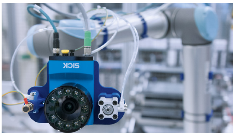
Obrázek 2.5: Optický robotický senzor společnosti SICK.
