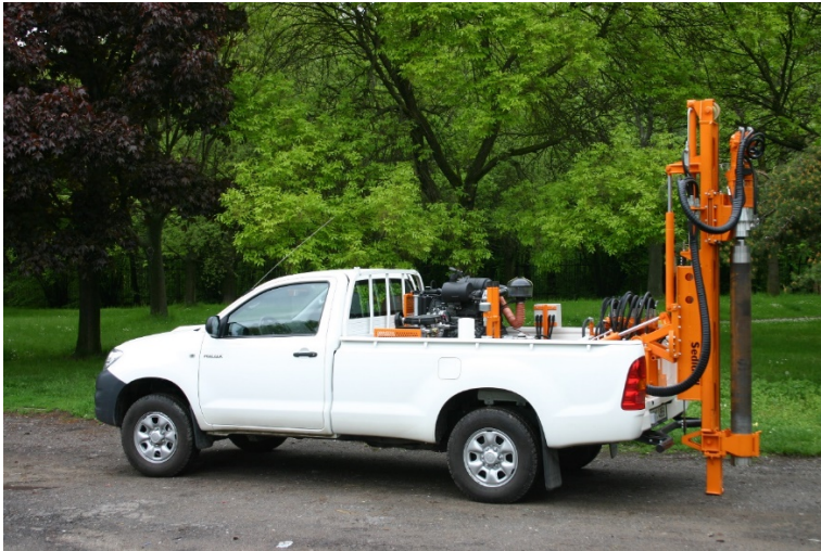
Obrázek 11 – Hydraulická vrtná souprava na odběr geotechnických sond
