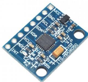
Obr. 20 – 6-osá gyroskopická stabilizace GY-521 MPU-6050 [56]
