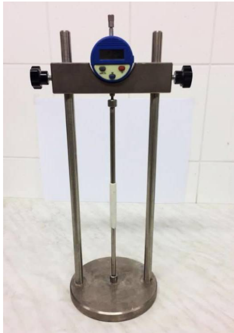
Obr. 6: Zařízení na měření smrštění
