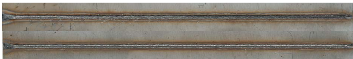
Obr. 47 - Líce svarů tloušťky 3 mm – nahoře ochranná atmosféra argonu, dole směsná ochranná atmosféra ArMix
