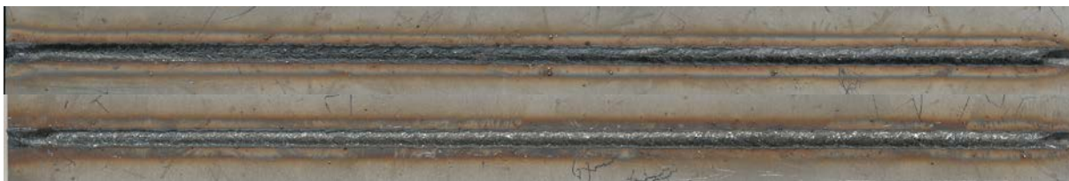
Obr. 49 - Lice svarů tloušťky 5 mm – nahoře ochranná atmosféra argonu, dole směsná ochranná atmosféra ArMix
