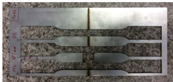
Obr. 53 Zbytek svařeného vzorku po vyřezání tahových vzorků a vzorků pro metalografii
