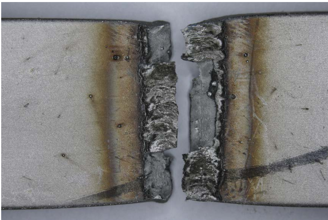
Obr. 68 Makrosnímek lomové plochy vzorku číslo 2 svařovaného v ochranné atmosféře argonu
