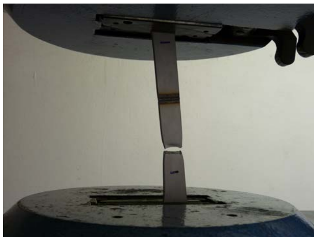
Obr. 66 Přetržení vzorku 1 tloušťky 5 mm
