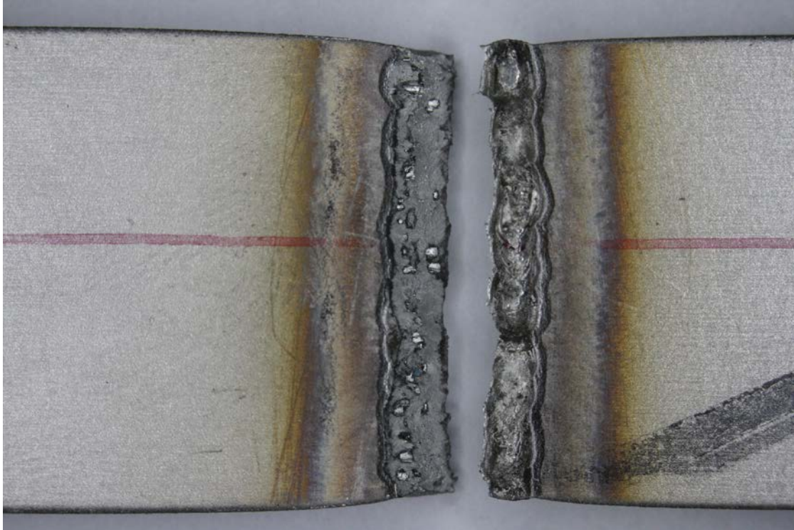
Obr. 69 Makrosnímek lomové plochy vzorku číslo 3 svařovaného ve směsné ochranné atmosféře
