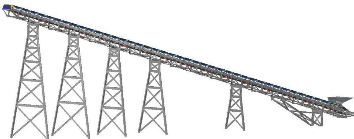
Obr. 23 Sestava dopravníku se stojinami z I profilů
