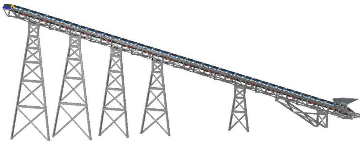
Obr. 23 Sestava dopravníku se stojinami z I profilů
