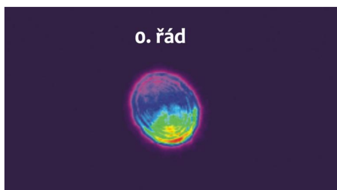
Obr. 24: Špatné nastavení vstupní polarizace
