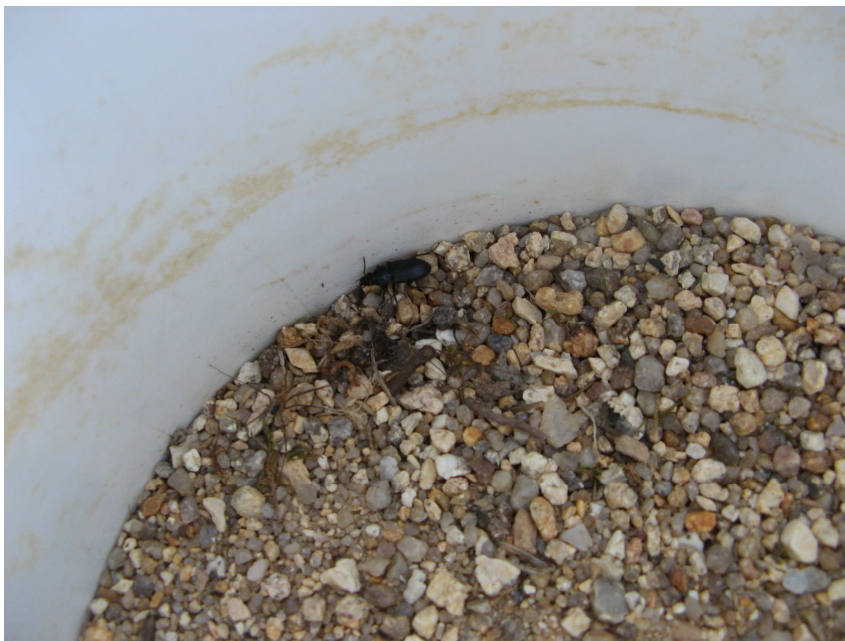
Obrázek 4: Detail vnitřního kbelíku zemní padací pasti s cca 5 cm písku, aby se nachytný hmyz mohl zahrabat
