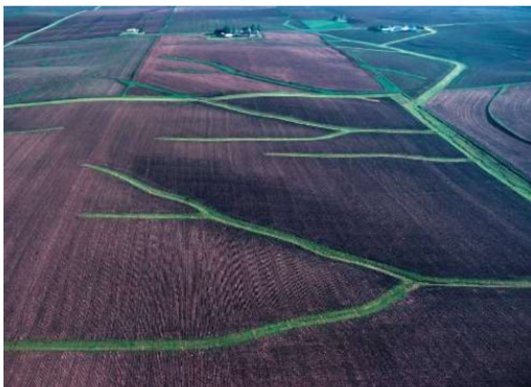
Obrázek 11 - Zatravněná dráha soustředěného odtoku (zdroj: https://docplayer.cz/45325965-Yhys-hydromelioracni-stavby.html )
