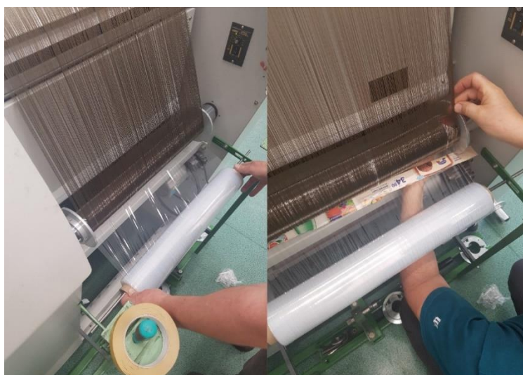
Obr.41: Příprava osnovy-snování, vlastní fotodokumentace
