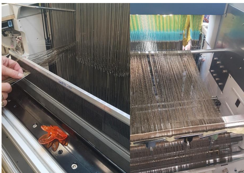
Obr.42: Příprava tkání – navádění, fotodokumentace
