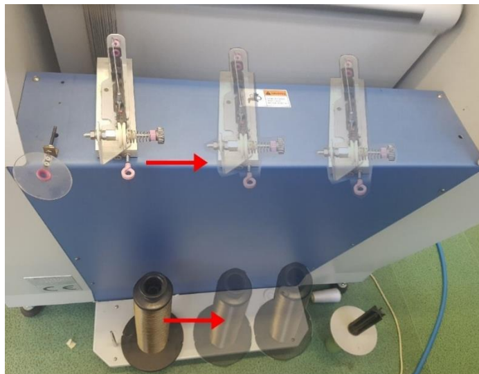
Obr.40: Příprava osnovy-snování, vlastní fotodokumentace a vizualizace
