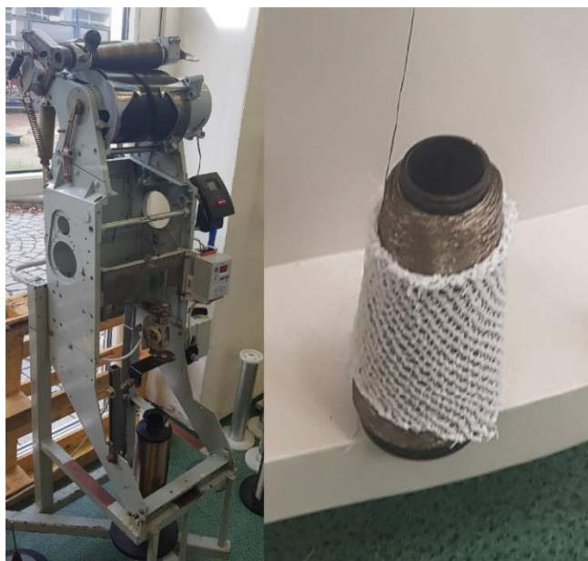
Obr.39: Příprava útku-soukání, vlastní fotodokumentace
