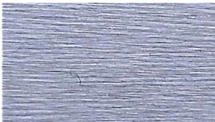
Obrázek 3.2: Fotografie měřeného vzorku (po operaci broušení)
