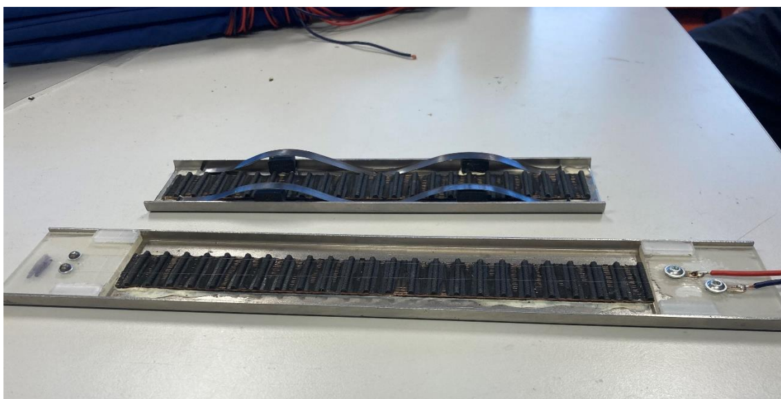
Obr. 20 Dvě části senzoru a jeho pružný systém (Zdroj: autor)
