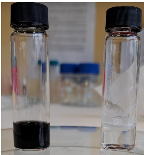
Obrázek 22: Porovnání interakce s vodou syntetizované disperze (vlevo) a grafitfluoridu (vpravo).
