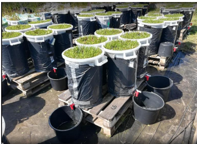
Obr. 4: Odebírání vzorků u jednotlivých skupin filtračních materiálů
