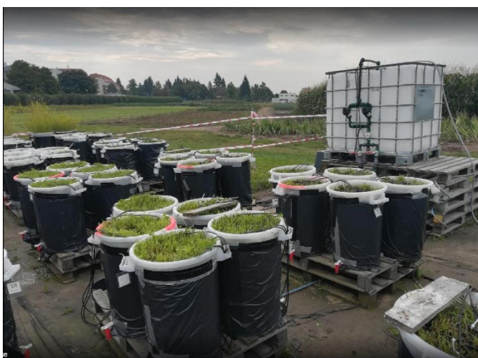
Obr. 5: Zavlažovací systém zajišťující aplikaci šedé vody z IBC kontejneru do zasakovacích pásů
