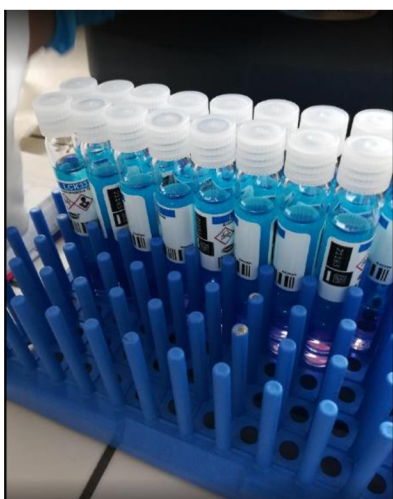
Obr. 7: Kyvetový test LCK332
