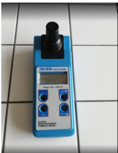
Obr. 6: Mikroprocesorový měřič zákalu HI 93703
