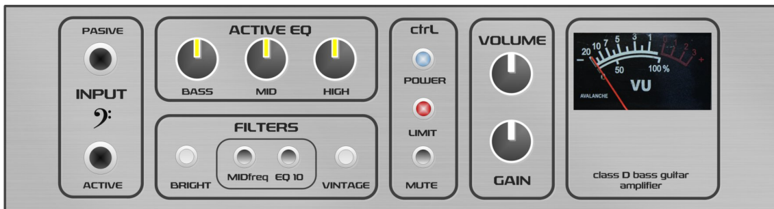
Obr. 5.3.1: Návrh rozloženia ovládacích prvkov na prednom paneli
