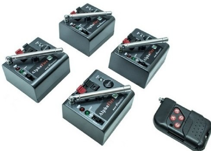
Obrázek 2.3: Sada odpalovacích zařízení prodejce Pyrostav.cz, obsahující vysílač a čtyři přijímače s jedním výstupem [6]
