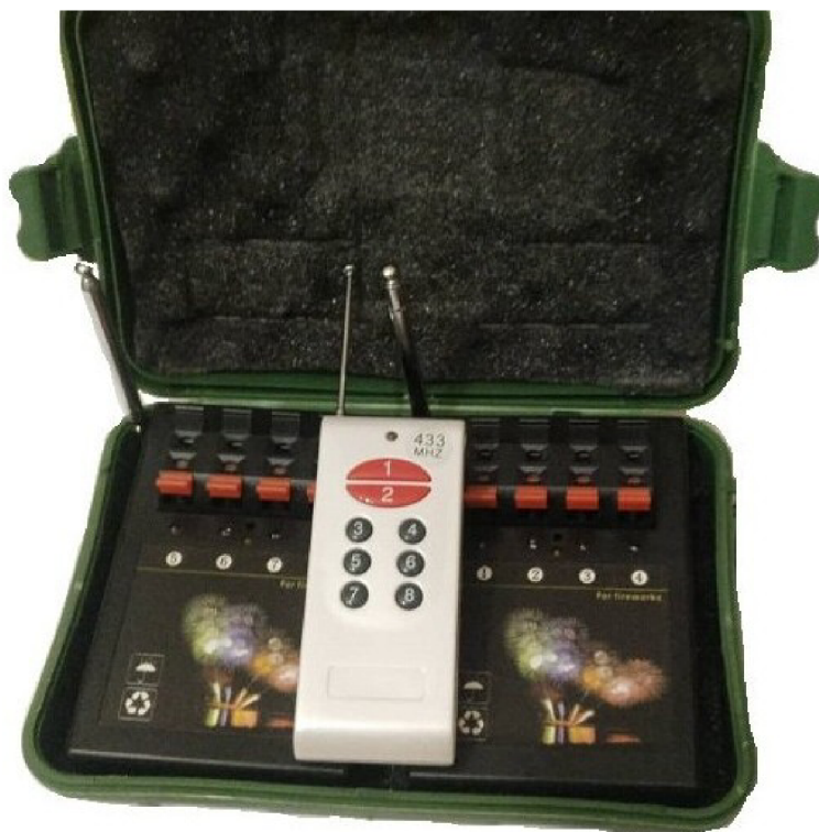
Obrázek 2.4: Sada odpalovacích zařízení prodejce CHILI ROSES.CZ, obsahující vysílač a dva přijímače se čtyřmi výstupy [2]
