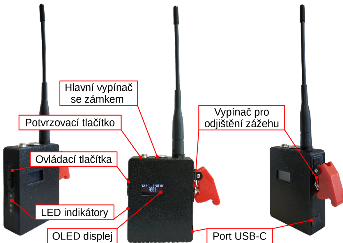
Obrázek 3.3: Popis vysílače dálkového systému pro zážeh zábavní pyrotechniky
