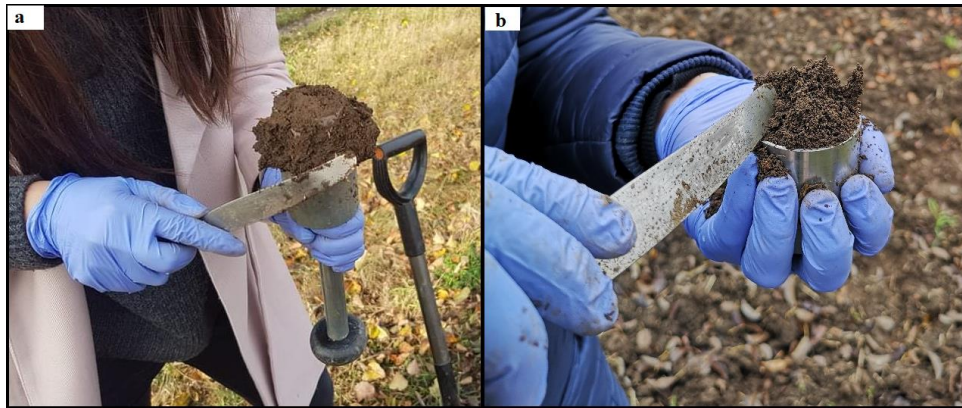
obr. 5 Odstranění přebytečné zeminy
