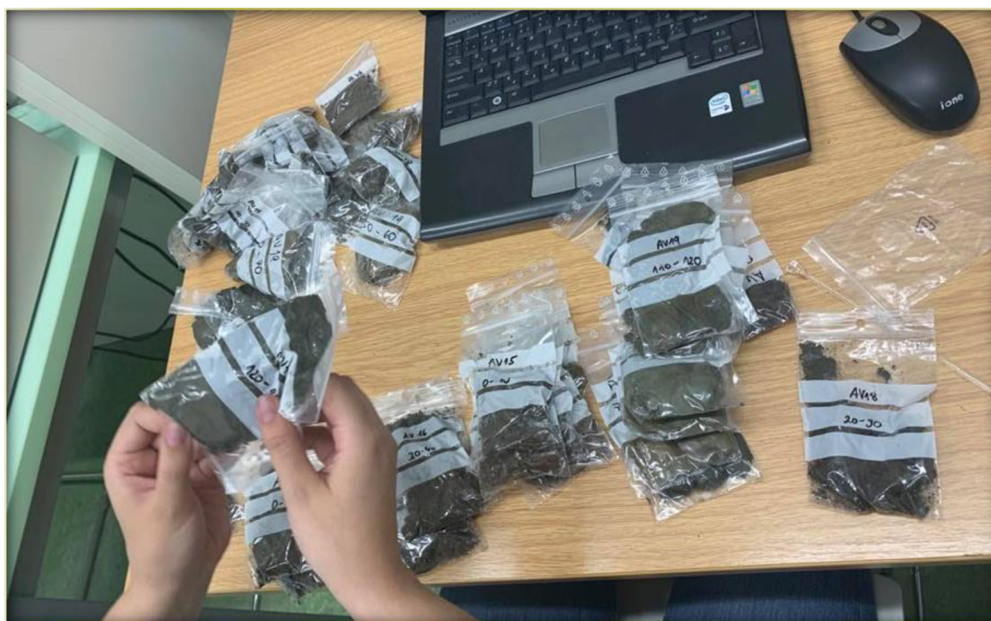
Obr. 6.: Vzorky připravené pro měření magnetické susceptibilita. Foto pořízeno Alicí Voráčovou 28. 8. 2020 na Katedře geologie UP.
