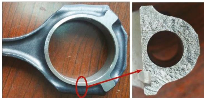
Obr. 6 Dělicí rovina ojničního oka vytvořená řízeným lomem [11]
