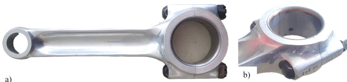
Obr. 26a) Ojnice motoru Mikron III C; b) detail hlavy ojnice
