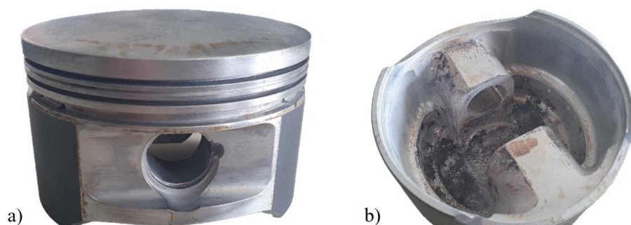
Obr. 24a) Píst motoru Mikron III C; b) vnitřní strana pístu
