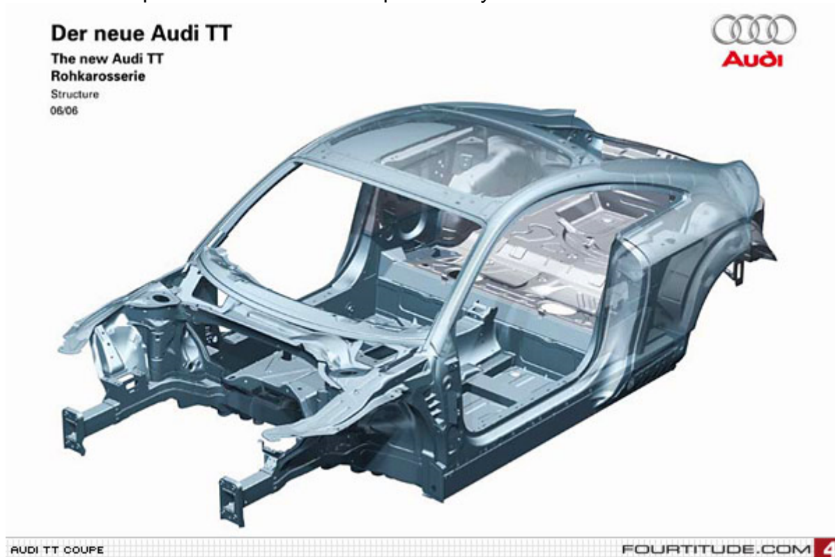
Obr. 14 Audi space frame u vozu Audi TT [15]
