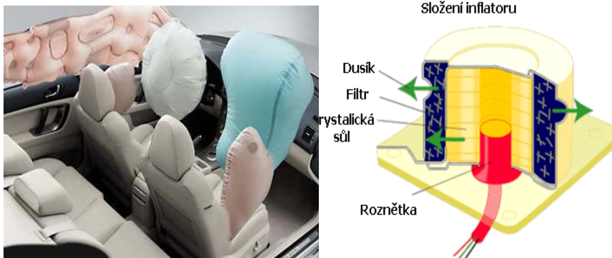
Obr. 17 Sestava airbagů a vyvíječ plynu airbagu [15]
