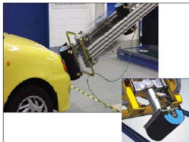
Obr. 6 Vystřelení a uchycení impaktoru stehna [6]
