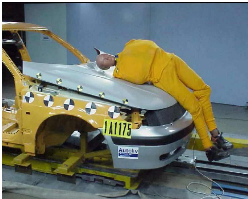
Obr. 11 Ukázka nárazu figuríny do aktivované aktivní kapoty [10]
