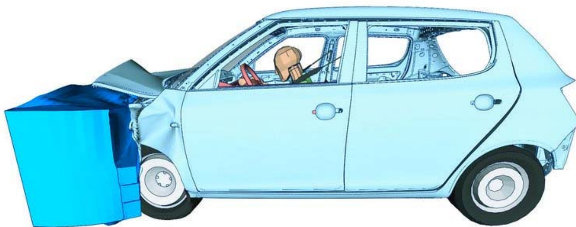
Obr. 20 Čelní náraz – simulace Škoda Fabia II [16]
