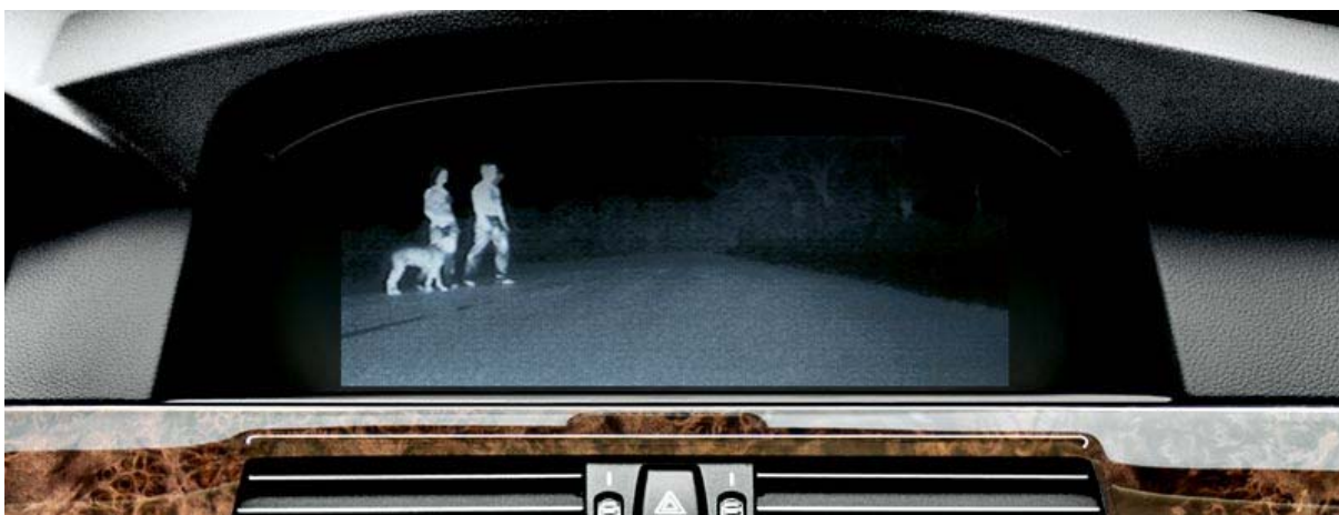
Obr. 16 Noční obraz na vnitřním displeji automobilu [11]
