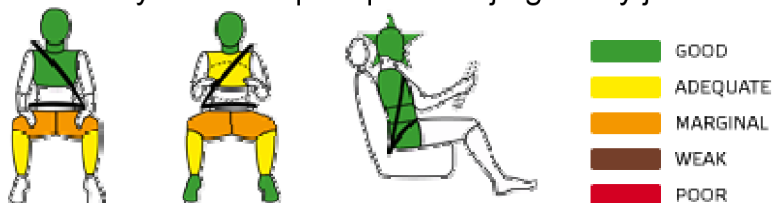
Obr. 25 Zleva: čelní náraz spolujezdec, řidič, boční náraz řidič, barevné odlišení Škoda Fabia II [1]
