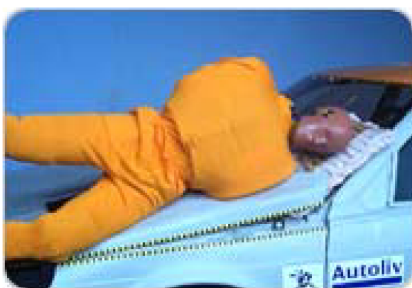
Obr. 13 Použití airbagů k ochraně chodců a jejich vliv na HIC [10]
