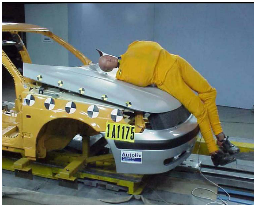
Obr. 11 Ukázka nárazu figuríny do aktivované aktivní kapoty [10]
