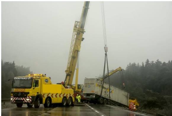
Obrázek 32 - Uchycení při vyprošťování pomocí tažných pásů (1)
