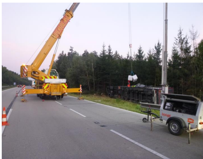
Obrázek 30 - Překládka u nákladního automobilu pomocí DEMAG AC 55(1)
