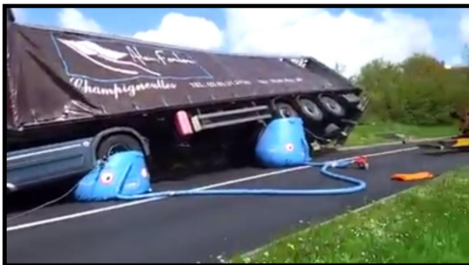
Obrázek 36 - Použití nafukovacích vaků (29)
