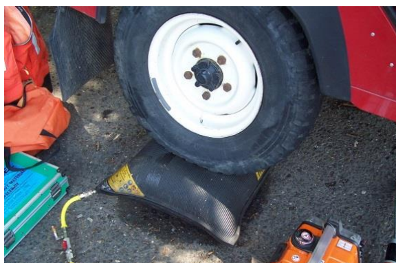
Obrázek 23- Použití pneumatického vaku (16)
