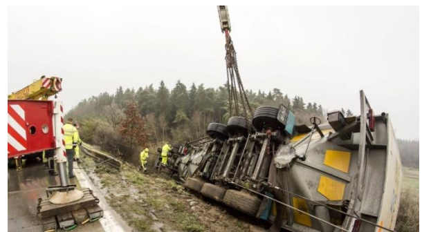
Obrázek 33 - Uchycení při vyprošťování pomocí tažných řetězů (1)
