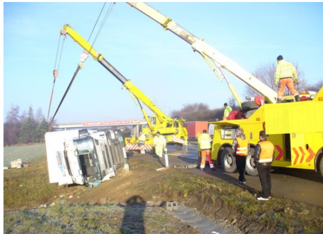
Obrázek 31- Vyprošťování pomocí dvou speciálů (1)
