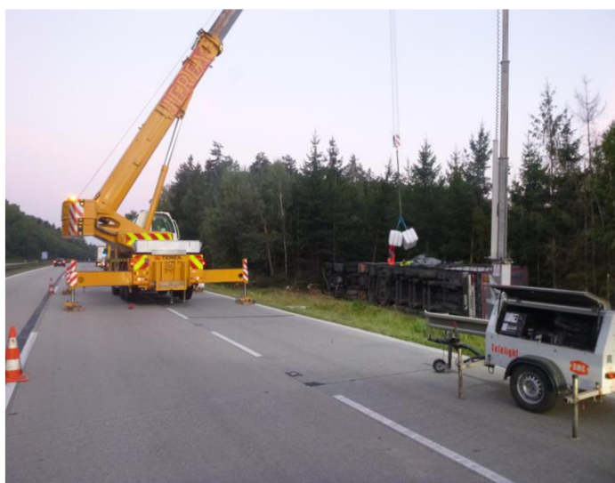
Obrázek 30 - Překládka u nákladního automobilu pomocí DEMAG AC 55(1)
