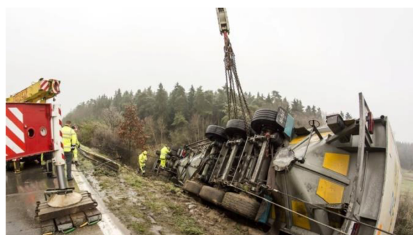
Obrázek 33 - Uchycení při vyprošťování pomocí tažných řetězů (1)
