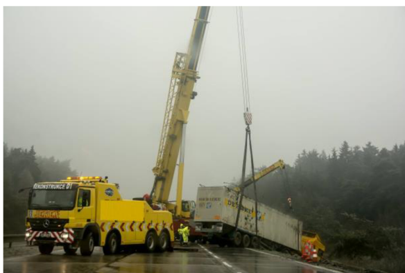
Obrázek 32 - Uchycení při vyprošťování pomocí tažných pásů (1)
