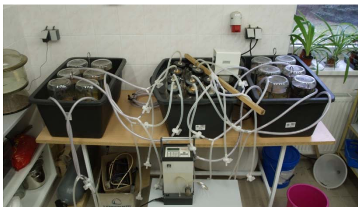
Obr. 14 – pohled na laboratorní sestavu fermentoru a nádob na jímání plynu (plynojemů)
