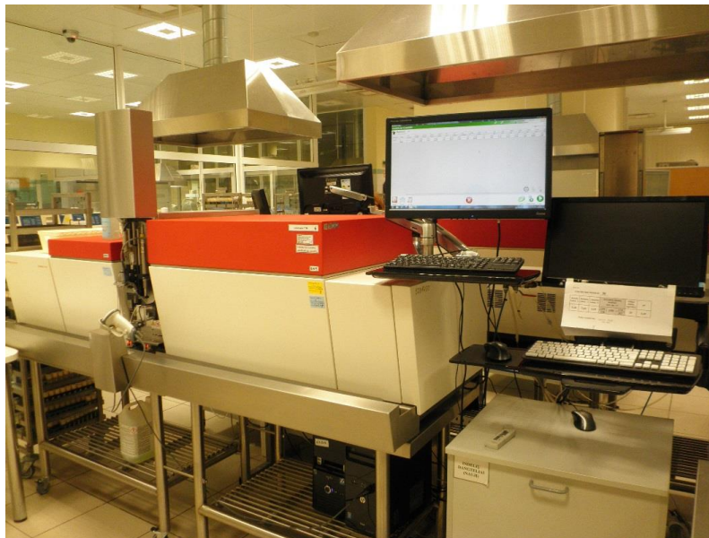
Obrázek 4 Přístroj CombiScope FTIR 600 (Delta Instruments B.V., Netherlands) pracující na principu FT-IR.
