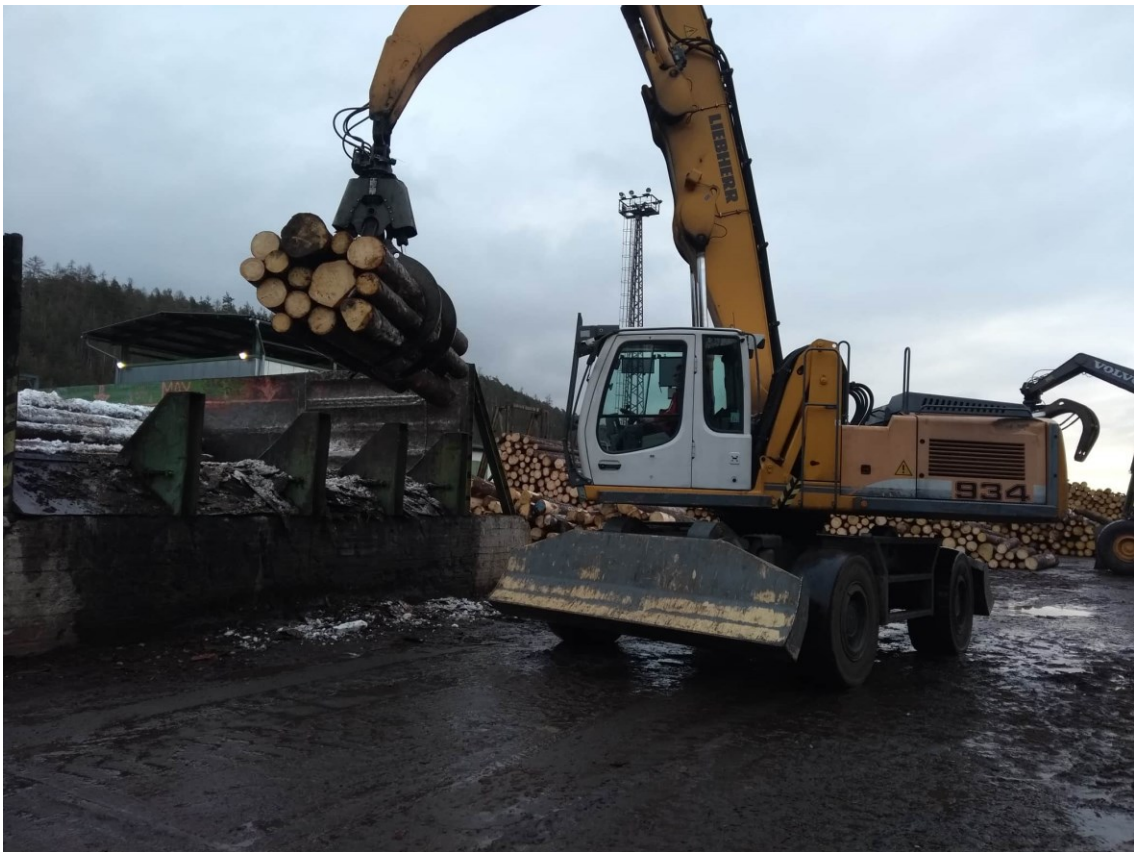
Obr. 2. 11 Rypadlo Liebherr 934 vybaveno drapákem
