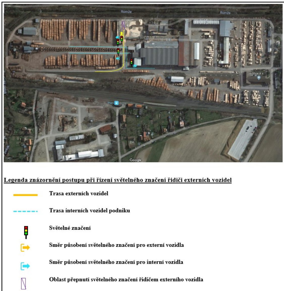
Obr. 3. 2 Znáznornění postupu při řízení světelného značení řidiči externích vozidel
