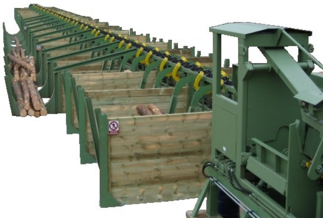
Obr. 1. 5 Manipulační linka na třídění výřezů
