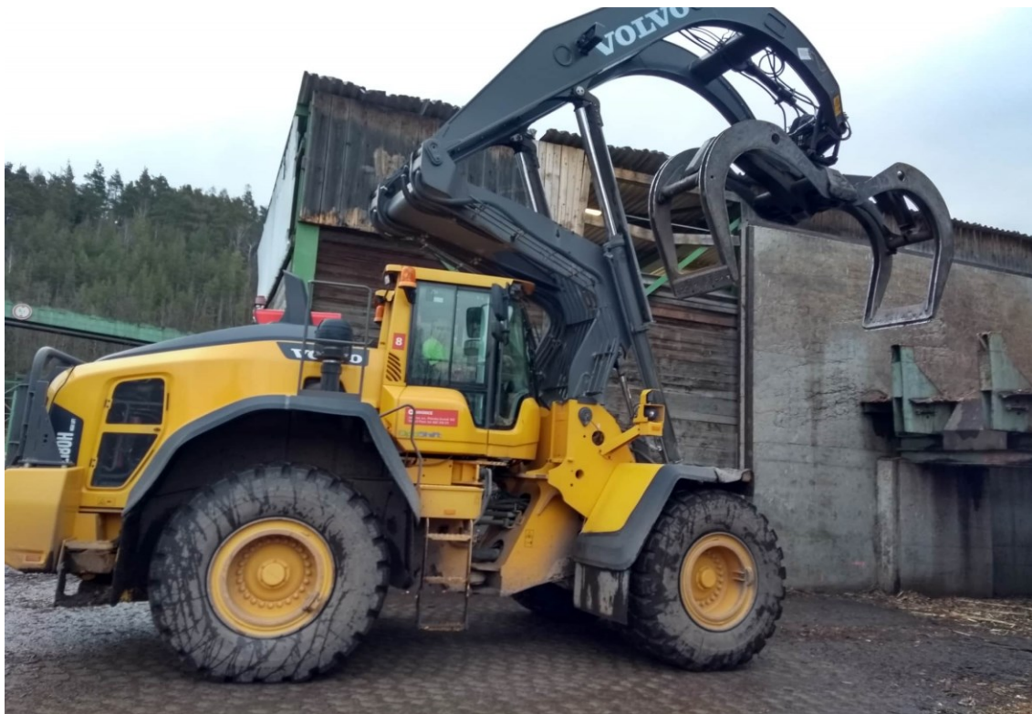
Obr. 2. 9 Nakladač Volvo V180 HL vybaven drapákem
