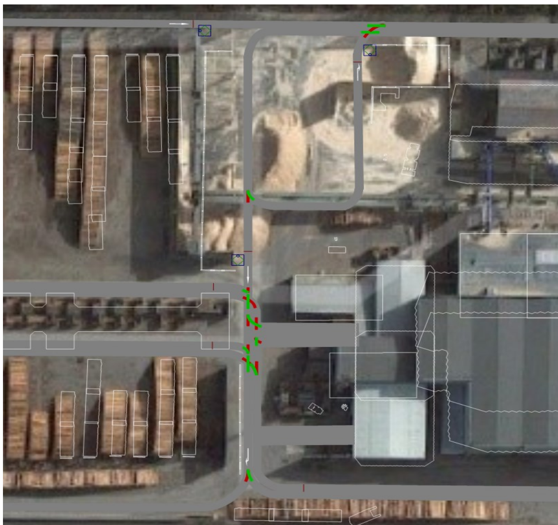
Obr. 3.13 Znáznornění konfliktních oblastí v místě frekventovaného pohybu vozidel v programu PTV Vissim
