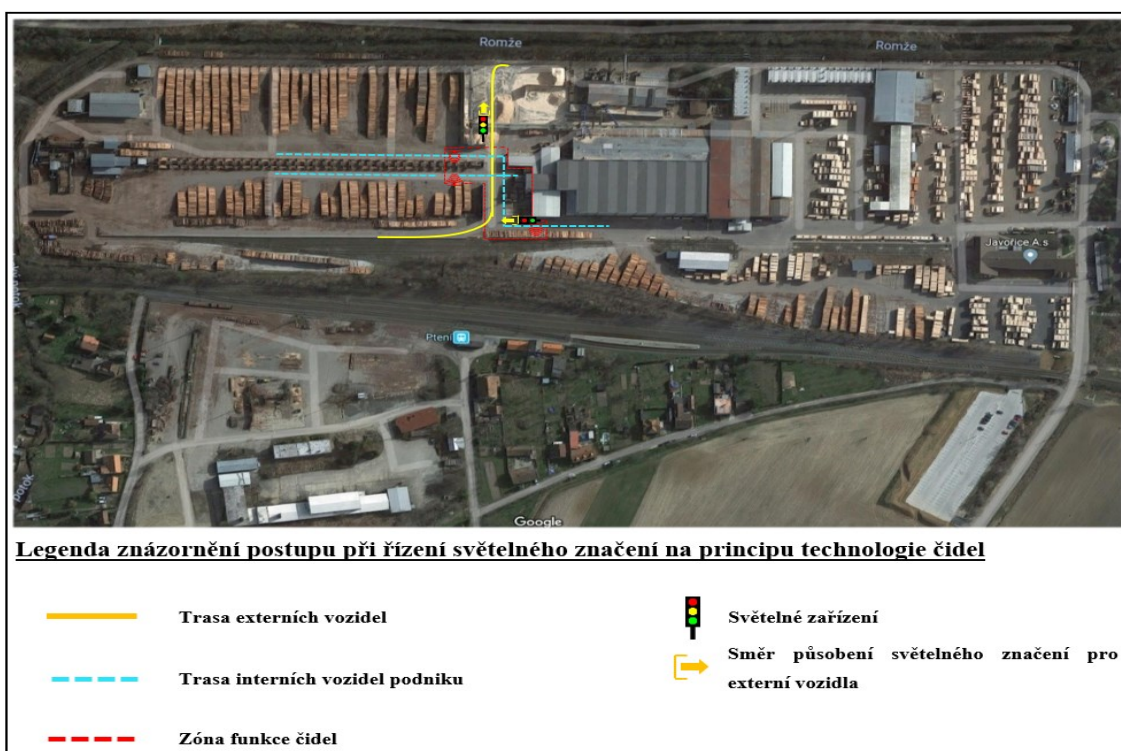
Obr. 3. 3 Znáznornění postupu při řízení světelného značení na principu technologie čidel
