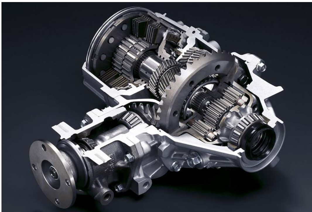
Obr. 4.15: Řez aktivním diferenciálem zadní nápravy systému S-AYC /15/
