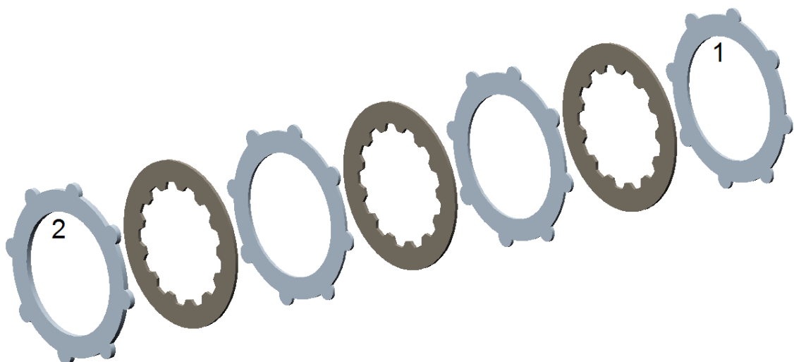
Obr. 5.5: Sestava vnitřních a vnějších lamel
