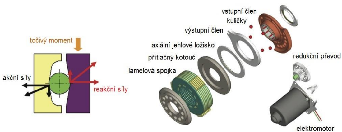
Obr. 4.11: Vačkový mechanismus aktivního M diferenciálu BMW /11/
