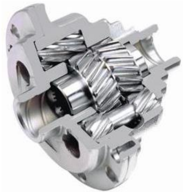
Obr. 3.6: Nápravový diferenciál Torsen typ B vozu Renault Mégane RS /8/
