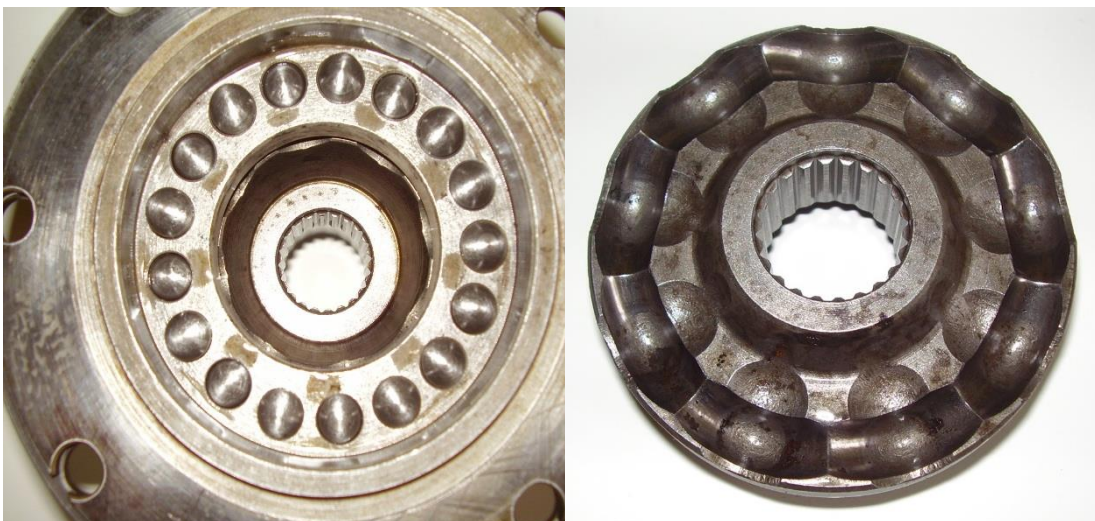
Obr. 3.1: Axiální kolíčkový diferenciál soutěžního vozu Škoda Favorit
