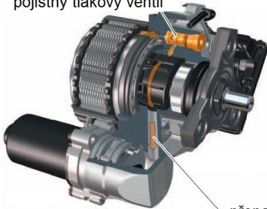
Obr. 4.5: Princip funkce pojistného tlakového ventilu /18/
