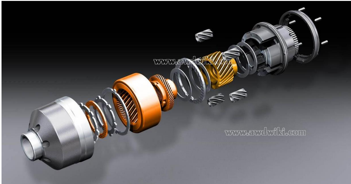
Obr. 3.7: Mezinápravový diferenciál Torsen typ C /9/
