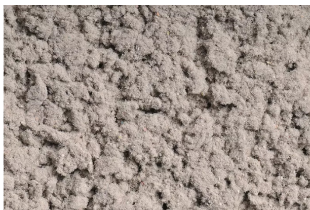
Obr. 13 Foukaná tepelná izolace z Celulózy
