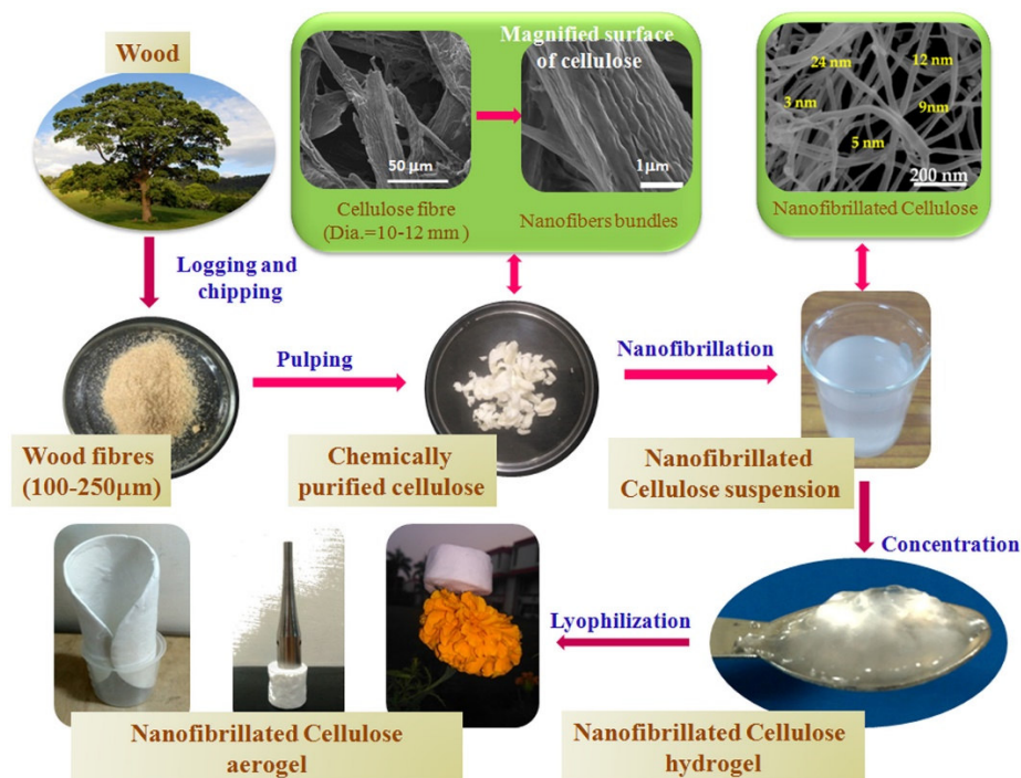
Obr. 21 Schematické znázornění syntézy nanofibrilovaného celulóзовého aerogelu
