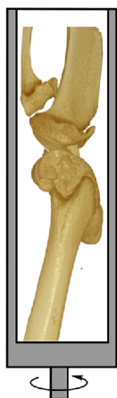
Obrázek 7.4: Ilustrace upevnění končetiny v držáku tomografické stanice ScanCo.
