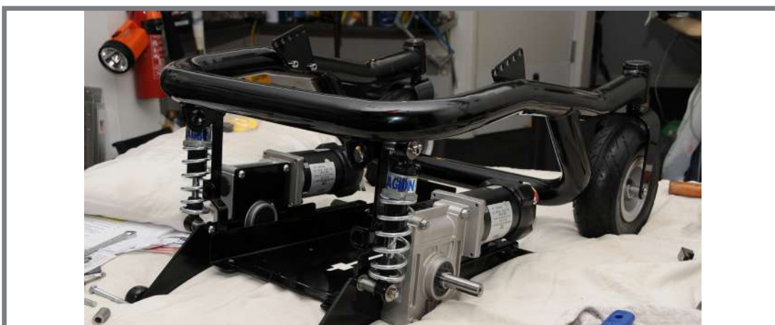
Obr. 2-26 Vnitřní konstrukce podvozku s elektromotory [38]
