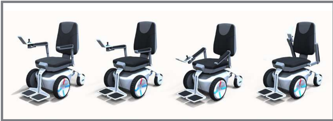
Obr. 6-65 Polohování opěrek při nasedání, nebo vysedání z vozíku
