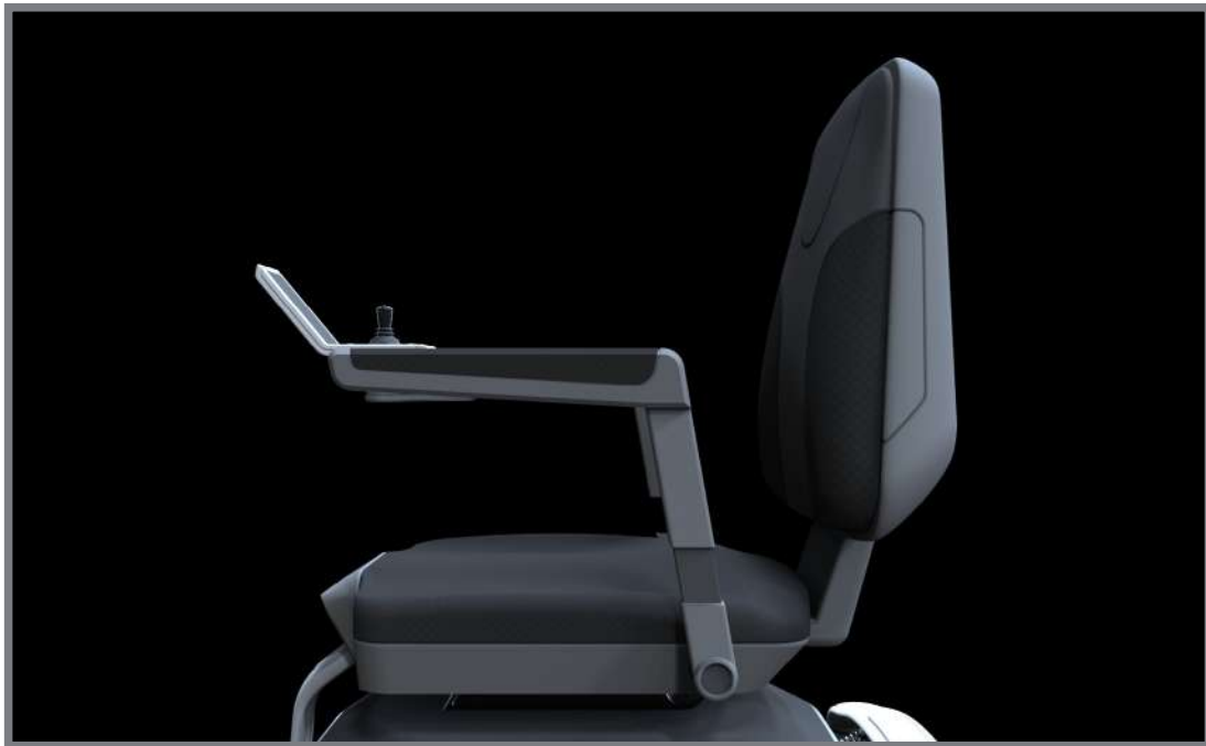
Obr. 5-53 Řešení uchycení područek pod sedákem rotačním kloubem
