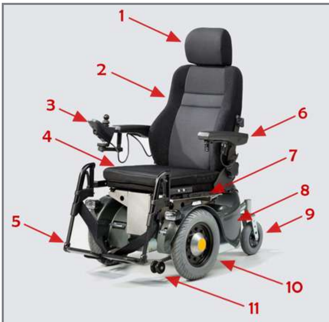
Obr. 2-23 Popis vnějších prvků vozíku Paravan PR30 [34]
