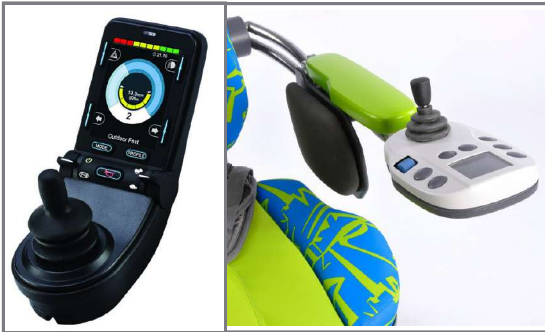
Obr. 2-34 Uživatelské rozhraní ovládacího panelu s joystickem [50]
