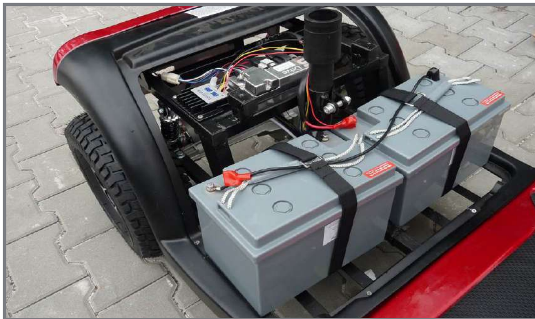
Obr. 2-27 Umístění sériově zapojených baterií [40]
