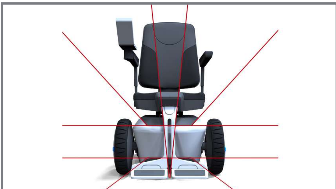
Obr. 5-52 Kompoziční řešení z čelního pohledu si zachovává určitý geometrický řád
