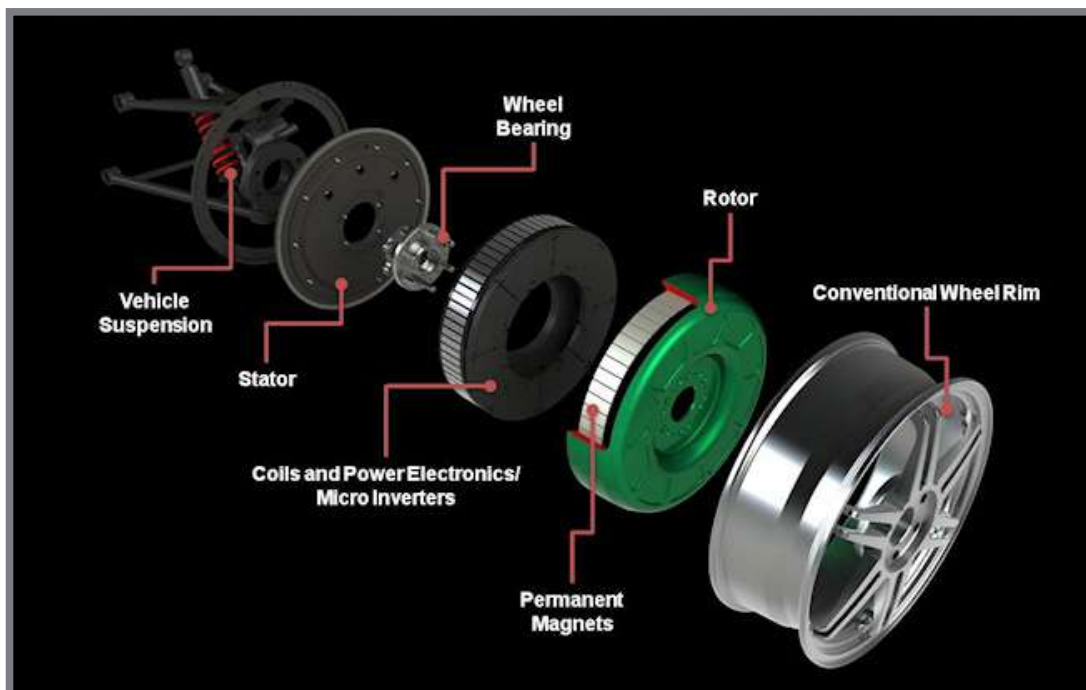
Obr. 4-42 Řešení motoru v disku kola [52]
