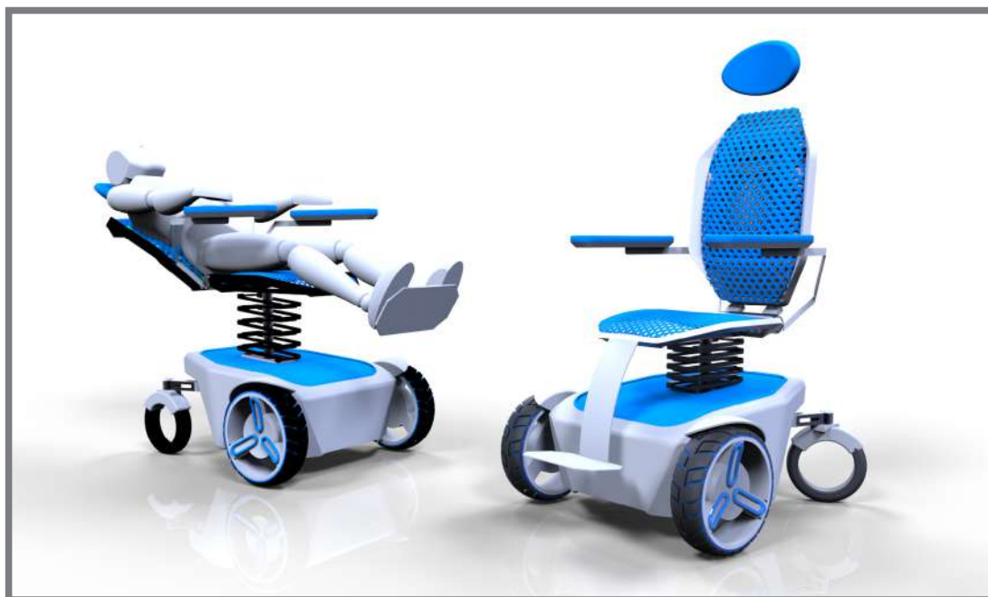
Obr. 4-40 Varianta II - perspektivní a ergonomický pohled - naklápění sedačky
