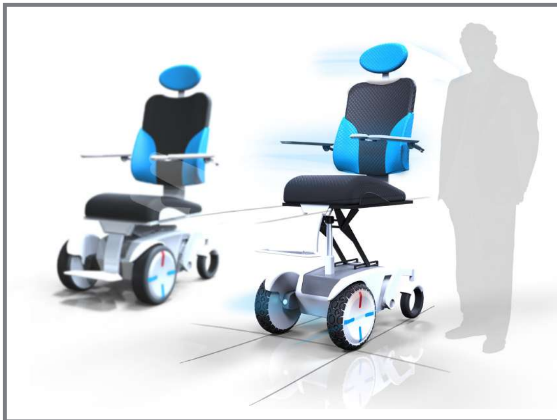
Obr. 4-38 Varianta I - perspektivní pohled - řešení zvedacího mechanismu
