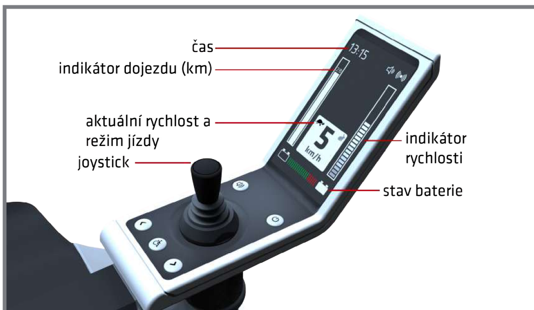
Obr. 7-72 Popis uživatelského rozhraní ovládacího panelu
