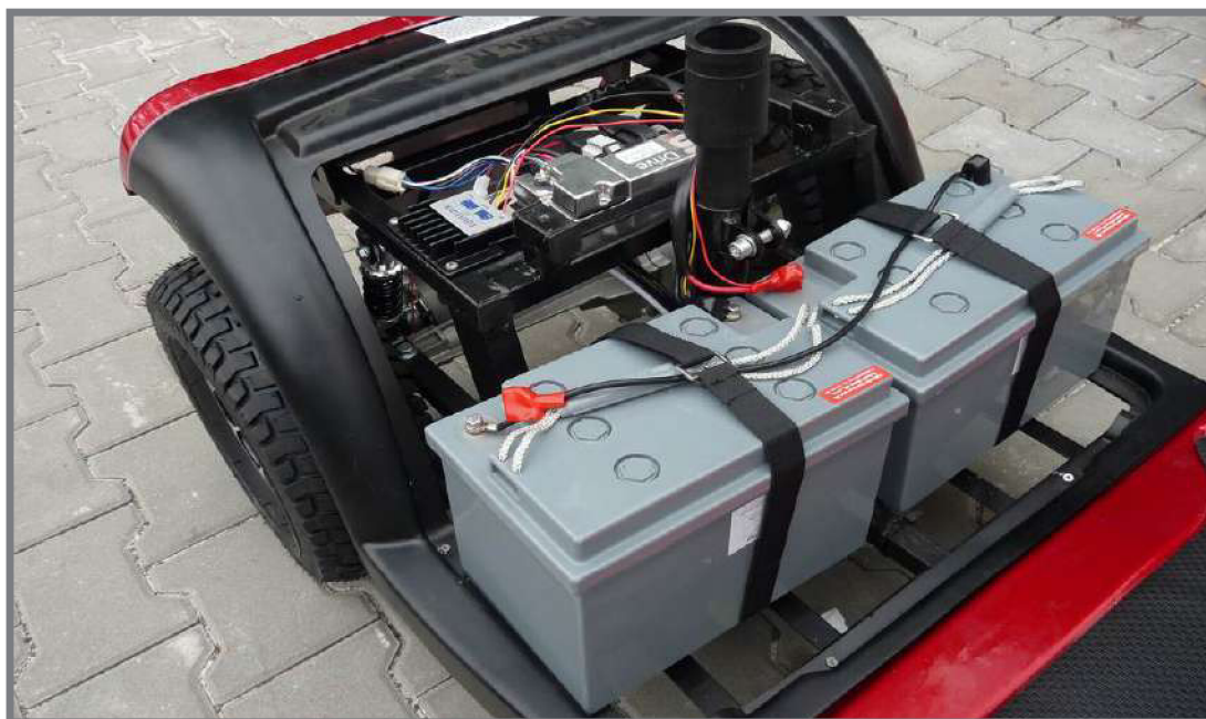
Obr. 2-27 Umístění sériově zapojených baterií [40]
