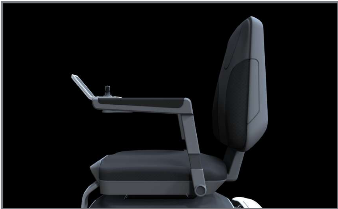
Obr. 5-53 Řešení uchycení područek pod sedákem rotačním kloubem
