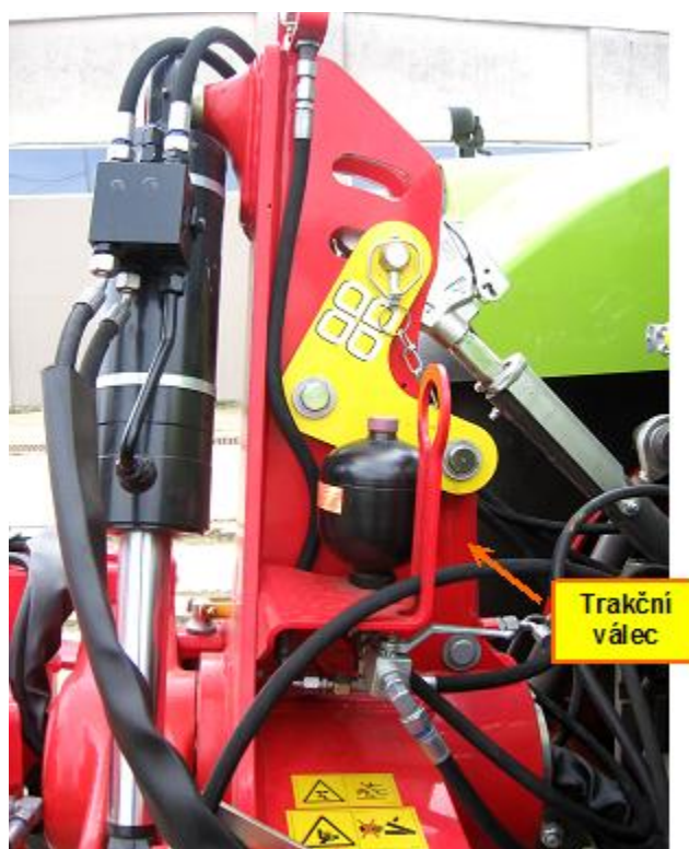
Obr. 24 Systém řízení trakce pluhu [1]
