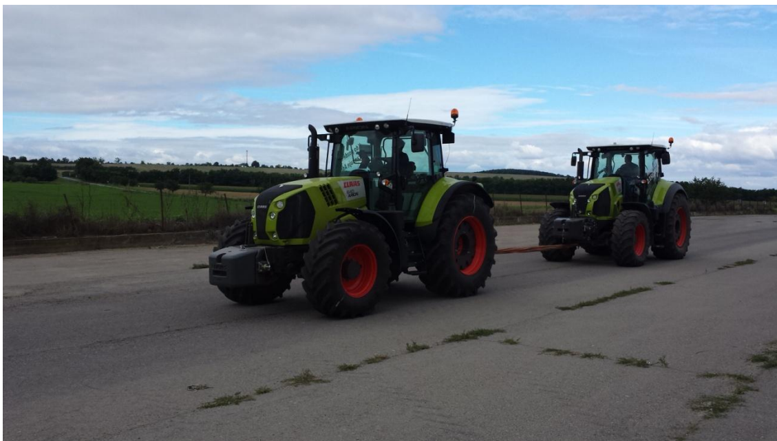
Obr. 16 Tahové zkoušky traktorů CLAAS ARION 640 na asfaltové podložce. Brzdící traktor CLAAS AXION 850
