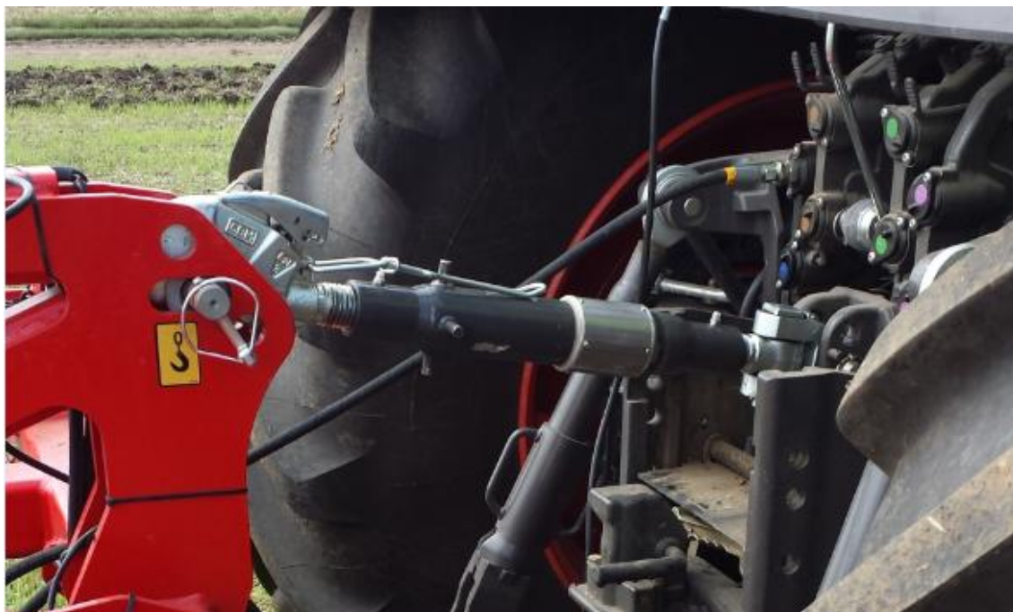
Obr. 17 Tenzometrický snímač síly společnosti Hottinger v horním táhle
