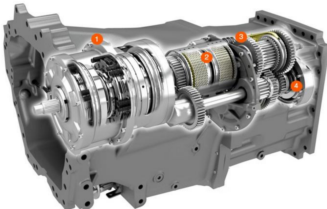
Obr. 6 Mechanická převodovka Claas HEXASHIFT [7]
