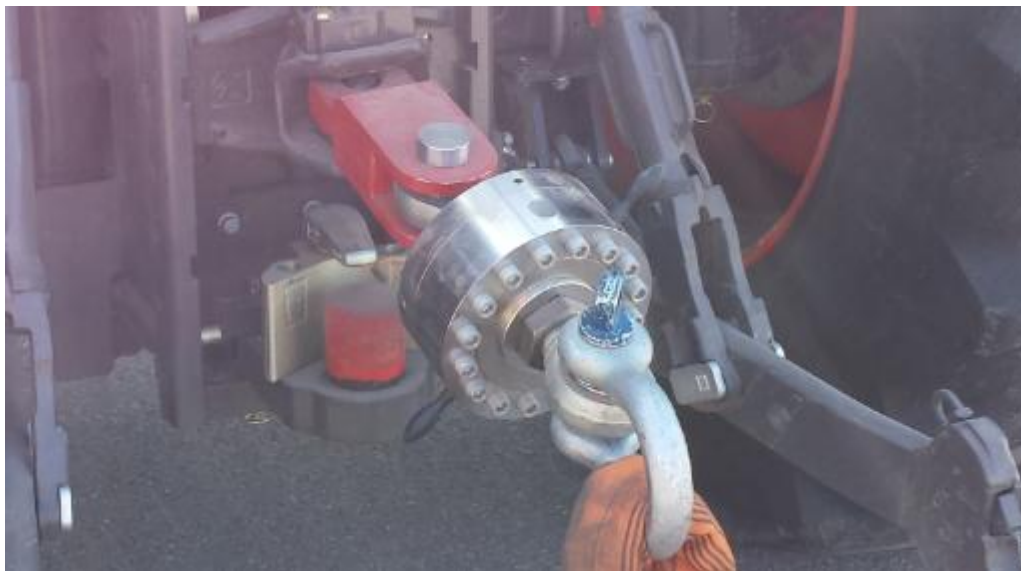
Obr. 15 Tenzometrický snímač síly Hottinger HBM U 10M
