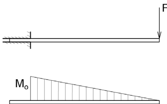
Obr.2.10: Únavová ohybová zkouška na vetknutém vzorku
