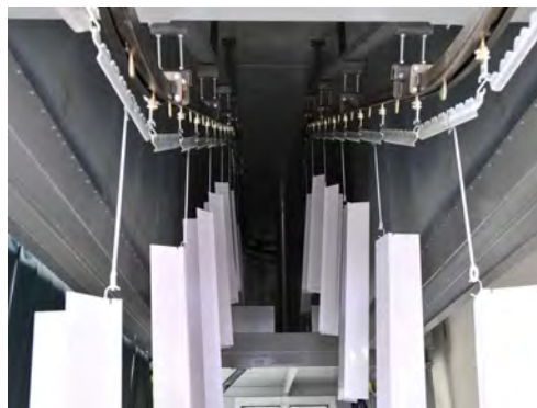
(b) Pohled do pece lakovací linky.
