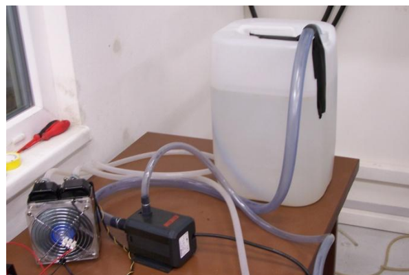
Obr. 31 Plastová nádrž, čerpadlo, pomocný ventilátor
