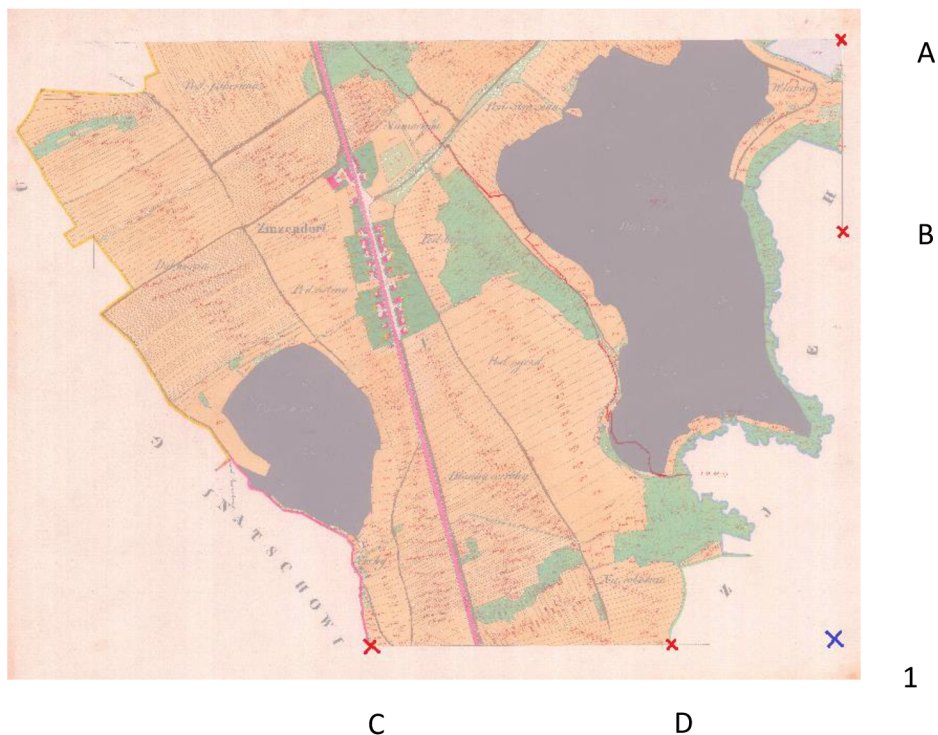
Obr. č. 5. 5. Rekonstrukce rohu mapového rámu
