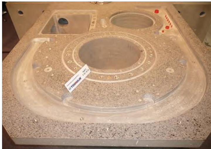
Obr. 44 Cementobetonové lože stroje POWERTURN [28]
