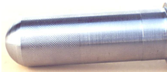
Obr. 30 Povrch poškozený samobuzeným kmitáním
