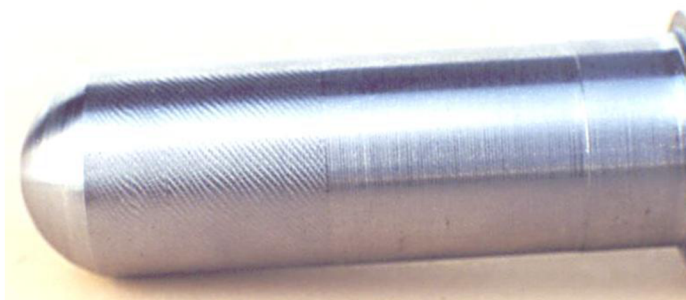
Obr. 30 Povrch poškozený samobuzeným kmitáním
