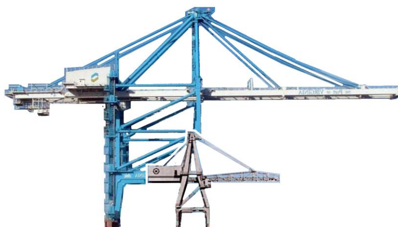
Obr. 13 Srovnání současného a prvního kontejnerového jeřábu v historii [21]
