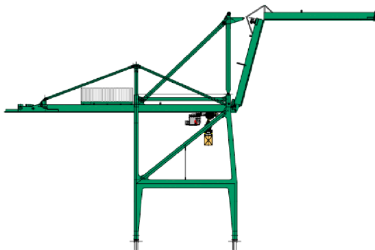
Obr. 16 Jeřáb profilu „A“ s kloubovým sklápěcím výložníkem [23]
