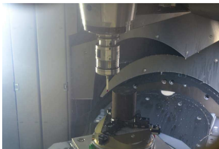
Obr. 10.2 Definování polohy polotovaru.
