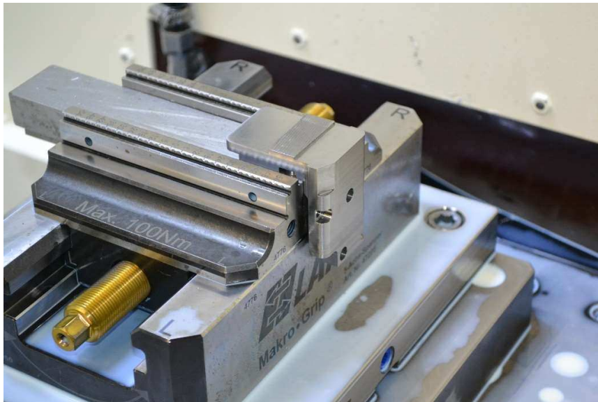
Obr. 10.5 Upnutí obrobku ve svěráku.
