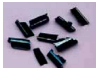
Obr. 3.12c [6] Kousky spirálové třísky.
