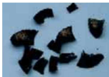
Obr. 3.12d [6] Kousky lámavé třísky.
