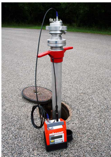
Obr. 3.4.2 Příklad akustické korelace - hydrofon [7]
