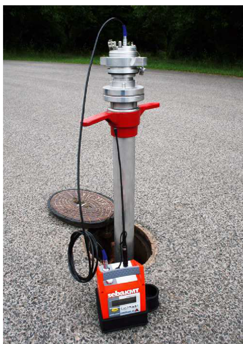
Obr. 3.4.2 Příklad akustické korelace - hydrofon [7]
